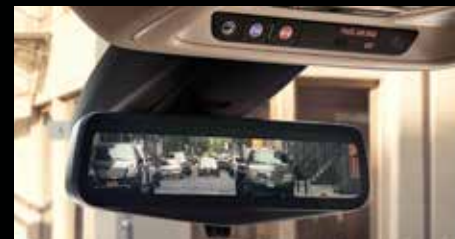
Vista trasera de la cámara de visión HD Full Mirror Display proyectada en el espejo retrovisor
